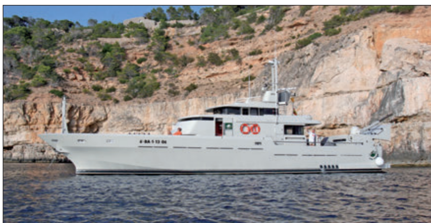
2007. BON PIGALL de la Fundació Argo Maris d'en Josep Quera, fondejat a Eivissa. Eslora 23,8 m, mànega 5,50 m, desplaçament 48 tones, velocitat 17 nusos, equipat amb un robot ROV preparat per a 500 m de fondària. Foto: Sebastià Mas.
