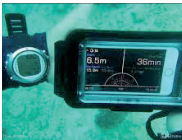
Carcassa per a telèfon mòbil, amb altres funcions útils per a la immersió, com profundímetre i brúixola a través de l'app associada a la carcassa. Foto: M. Carme Mallofré.
