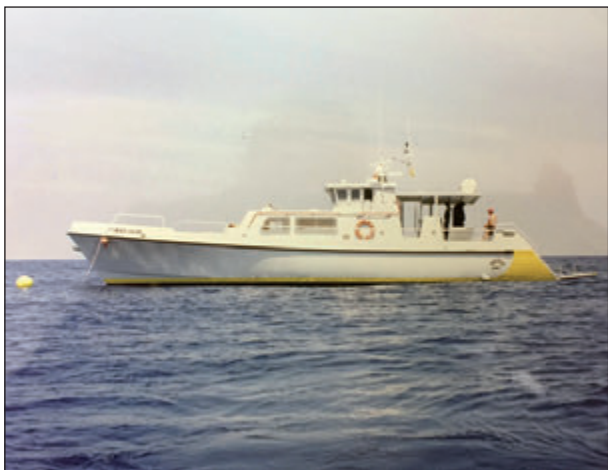
2001. BON GENI després de ser ampliat 2,5 m per assolir 18 m d'eslora total. Foto: Neus Abad.
