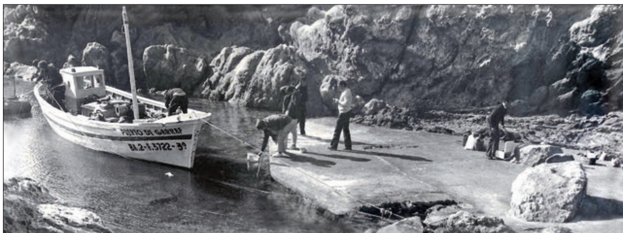
1970 novembre. Embarcació «PUERTO DE GARRAF» a l'embarcador de Cala Cullaró al Cap de Creus en una sortida d'immersió i posterior arrossada. Eslora: 8,2 m; Mànega: 2,5; Motor: Dièsel d'un sol pistó i engegada manual amb manovella. Casc de fusta. Matricula BA 2-F 3722-3ª. Foto: Manel Puyalto.
