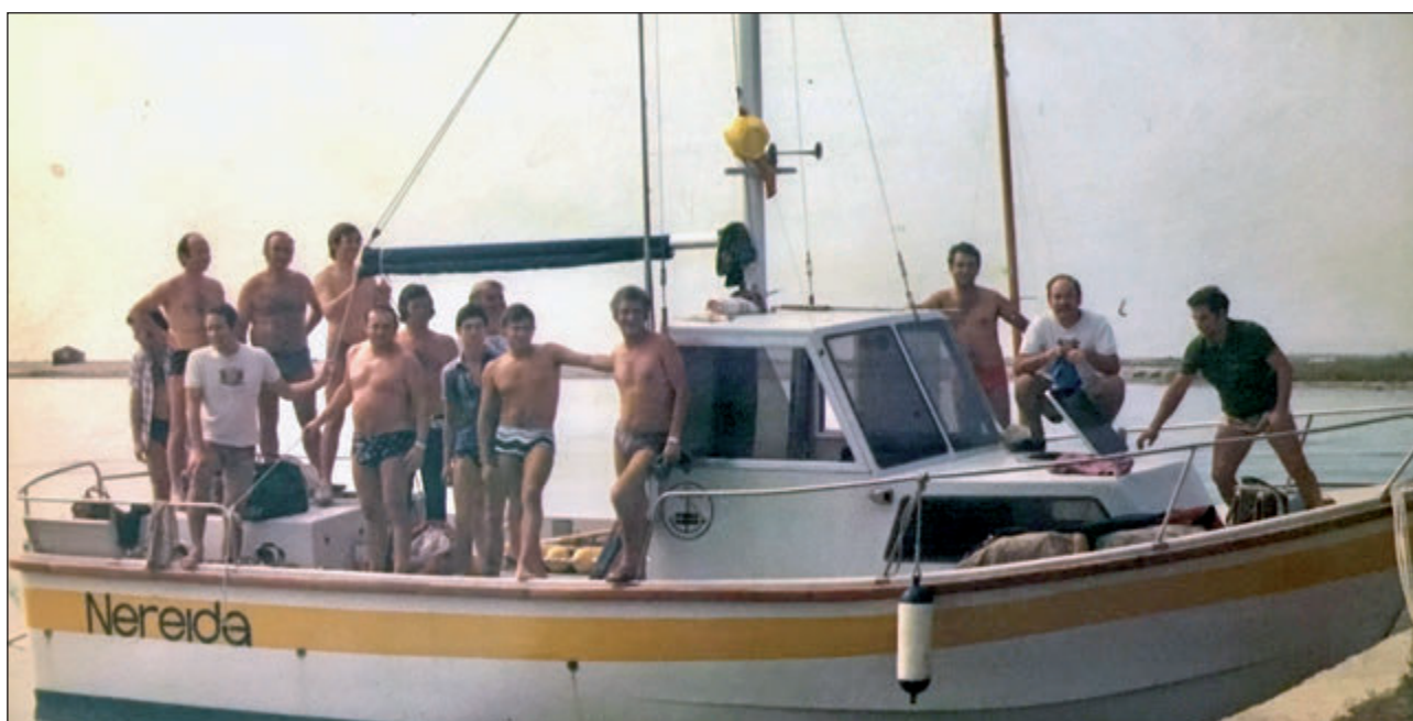
1973 juliol. Embarcació «NEREIDA» als Canals de Santa Margarida, amb el grup de socis copropietaris i algun invitat a bord preparats per a una sortida d'immersió al Cap de Creus. Eslora: 8,65 m; Mànega: 3,08 m; Puntal 1,66 m; Motor: Dièsel de sis cilindres marca Perkins i 80 HP Casc Noray 30 de fibra de vidre. Matricula 5ª BA-2-5311. Equipada amb un motor Dièsel marca Mini-Soler de nou HP per fer funcionar un compressor d'alta marca BAUER. Foto: Un soci copropietari.
