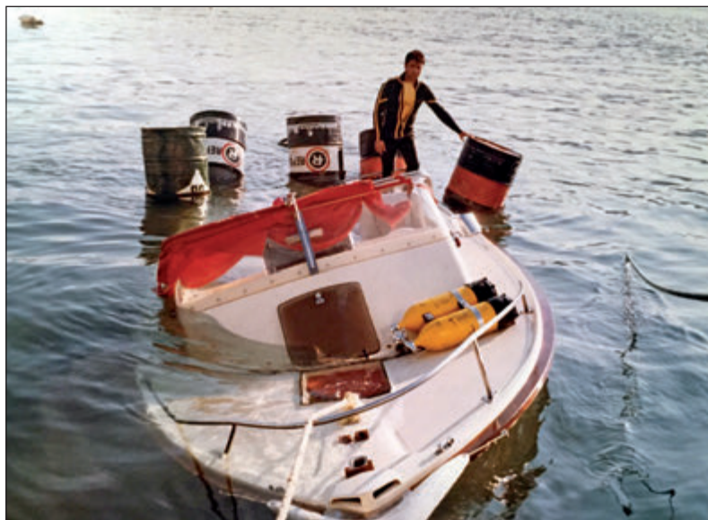
1971. Cadaqués. Reflotament de l'embarcació d'en Benet Carbonell, enfonsada dins la rada de Cadaqués a conseqüència d'un temporal de mar i pluja. Sobre l'embarcació Josep Quera amb els bidons utilitzats com a globus pel refloatament. Foto: Josep Verdaguer.
