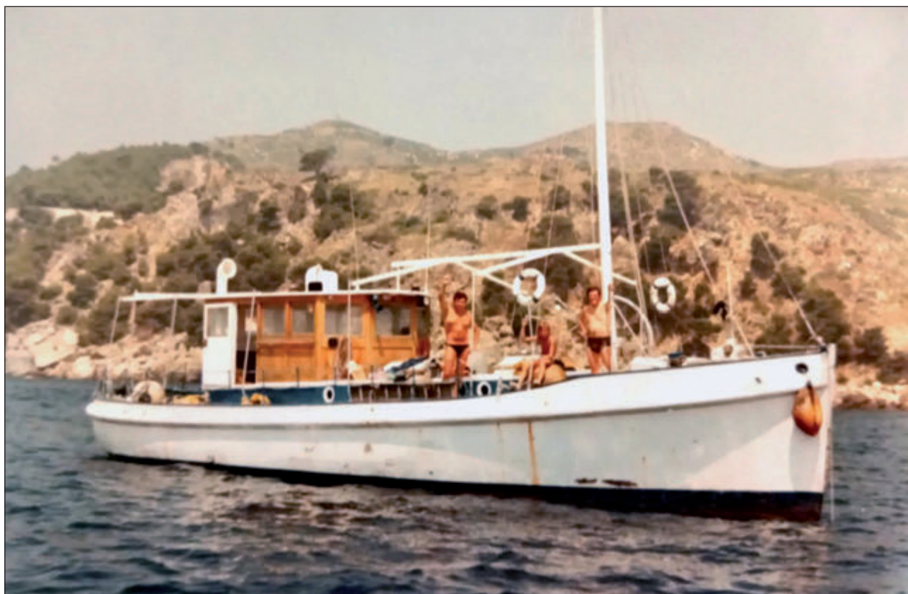
1980. Embarcació «VALLCARCA» fondejada als indrets de Cala Montjoi (Roses). Eslora: 15,50 m; Mànega: 4,40; Puntal: 2,31 m; Motor: Dièsel de quatre cilindres marca KELVIN de 110 HP. Casc de fusta de pi de melis. Foto: Un soci copropietari.
