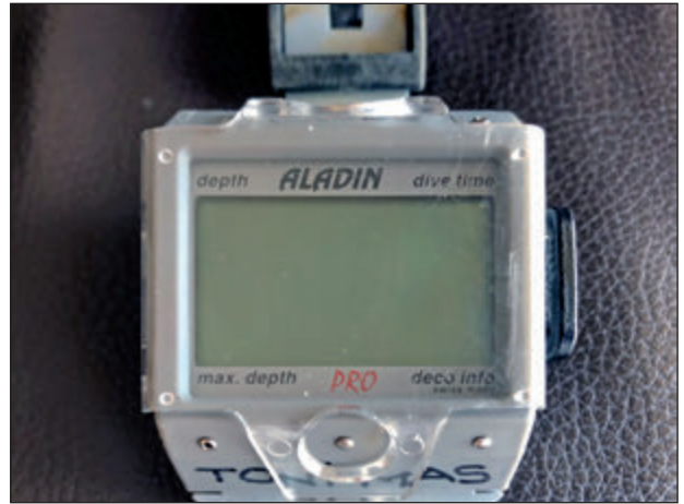
2000/2010. Ordinador submarí marca Uwatec model Aladin de fabricació suïssa. Analitza i processa totes les fases de la immersió, facilita i memoritza els temps de descompressió amb total precisió. Foto: Sebastià Mas.
