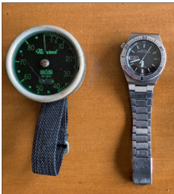
1960/1970. Aparells analògics bàsics utilitzats per a la pràctica de l'escafandisme esportiu. D'esquerra a dreta: Profundímetre amb bany d'oli marca Nemrod. Rellotge submarí marca Pulsar resistent fins a 100 m de profunditat. A la dreta taules de descompressió Nemrod.
