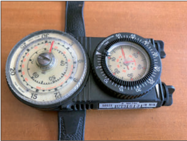
1980/1990. Aparell analògic marca Mega Sport de fabricació italiana que integra Profundímetre. - Memoritzador del temps d'immersió. - Rellotge i Taules de descompressió preestablertes. Foto: Sebastià Mas.
