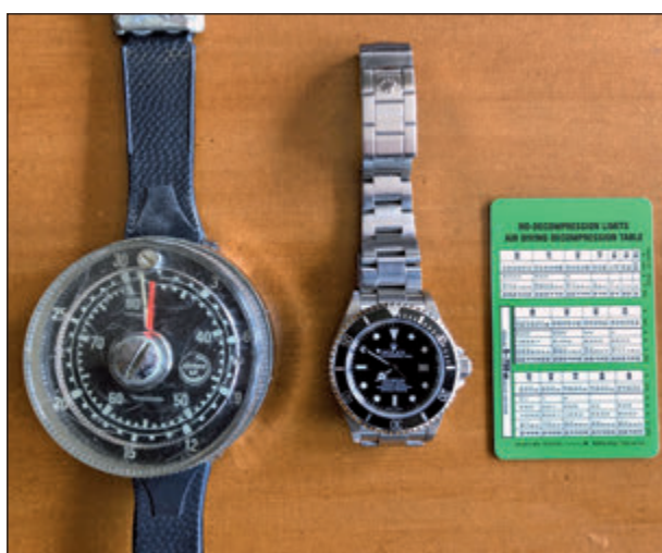
1970/1990. Aparells analògics bàsics utilitzats per a la pràctica de l'escafandisme esportiu. D'esquerra a dreta: Profundímetre amb agulla de memòria de la profunditat màxima assolida durant la immersió, marca Mega Sport de fabricació italiana. Rellotge submarí d'alta resistència i fiabilitat marca Rolex resistent fins a 4000 ft = 1220 m. Taules de descompressió Rolex.
