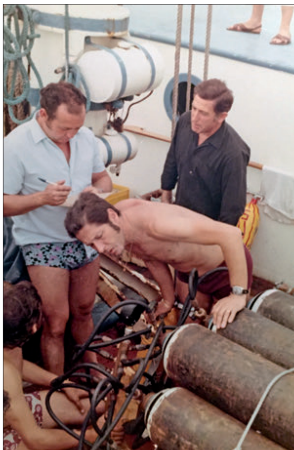
1972 juny. Columbretes. Transvasament d'aire comprimit de les ampolles industrials a les d'immersió a bord del pailebot Roger de Flor. D'esquerra a dreta: Ramon Rambla, Josep Fabregat i Víctor Colomer efectuant l'operació. Foto: Manel Puyalto.
