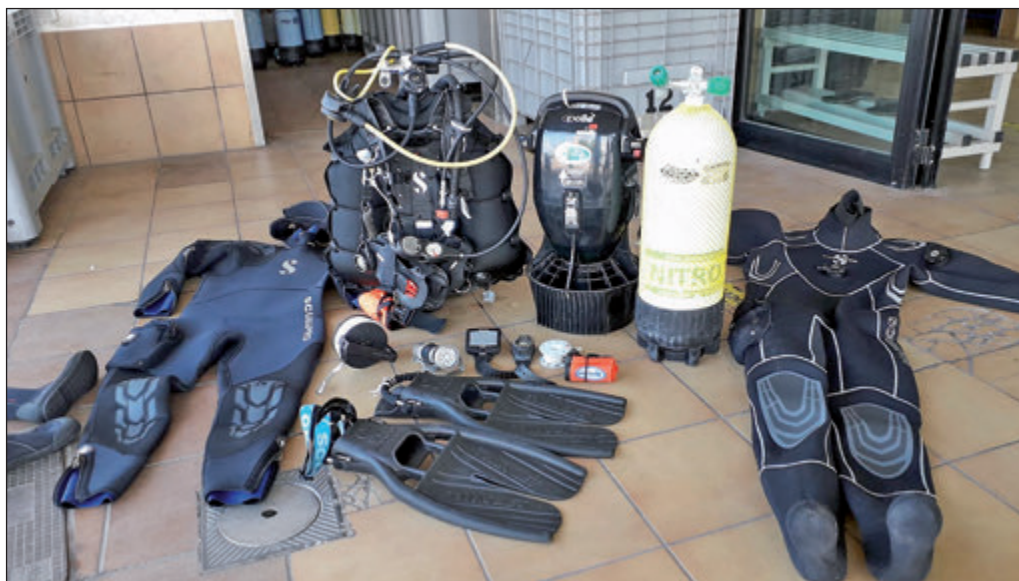
Equip actual complet d'escafandisme. D'esquerra a dreta: escarpins, trajo de neoprè, escafandre format per ampolla d'aire comprimit de 12 l, reguladors principal i d'emergència, manòmetres per al control del volum d'aire comprimit, armilla compensadora (Jacket), llast (ploms) integrats a l'armilla, remolcador elèctric (scooter), ampolla de 12 l de Nitrox, trajo sec, aletes, rodet amb cordill guia, llanterna de leds, ordinador d'immersió, brúixola, rodet amb cordill i globus de senyalització i ganivet (no inclòs a la foto). Foto: Joan Cerdà.
